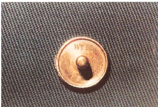
FIGURA 4 - Fotografia onde observa-se a placa emissora de radiação beta do estrôncio
